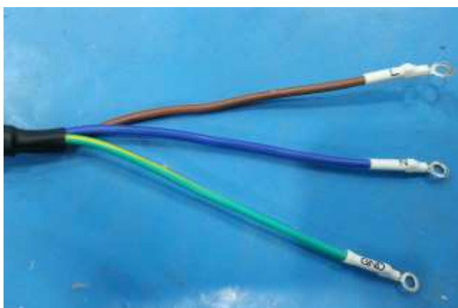
Obrázek 4-4. Příkon, 200-240 V, 0,5 A, 50 / 60Hz, jednofázové
